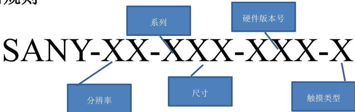
产品型号编码规则：SANY-液晶分辨率缩写-系列代码+尺寸-硬件版本号+触摸类型。
